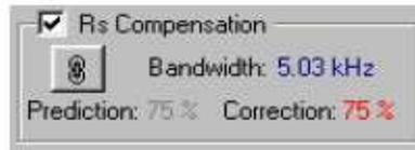
Glider コントロールを使い、オシロスコープで Primary Output 信号を確認しながら、ゆっくりと目標を目指して Prediction もしくは Correction のパーセントを設定します。トレースはノイズが大きくなり、立ち上がりエッジは速くなり、トランジェントの立ち上がりが大きくなります。設定が 80%付近を超えるとトランジェントは大きくなり、急激に増減して本格的に発振します。この Rs 補正の方法は Bandwidth との連携を上手に行えば、Prediction と Correction は振動がなければ最高の補正を提供します。詳細は Chapter 5 の SERISE RESISTANCE COMPENSATION で説明します。
